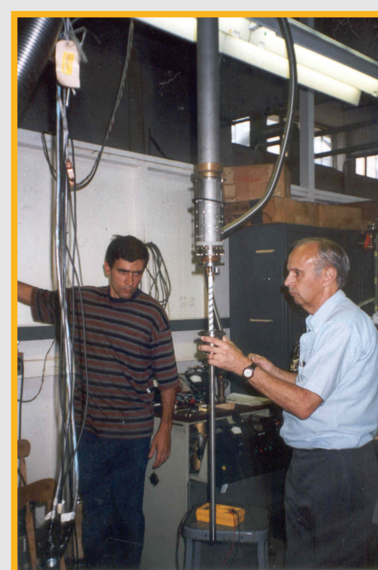
Detalhes de construção e montagem do refrigerador que operou a 0,02 K sob um campo magnético de 35 T, portando quatro experimentos diferentes, em 1995.
