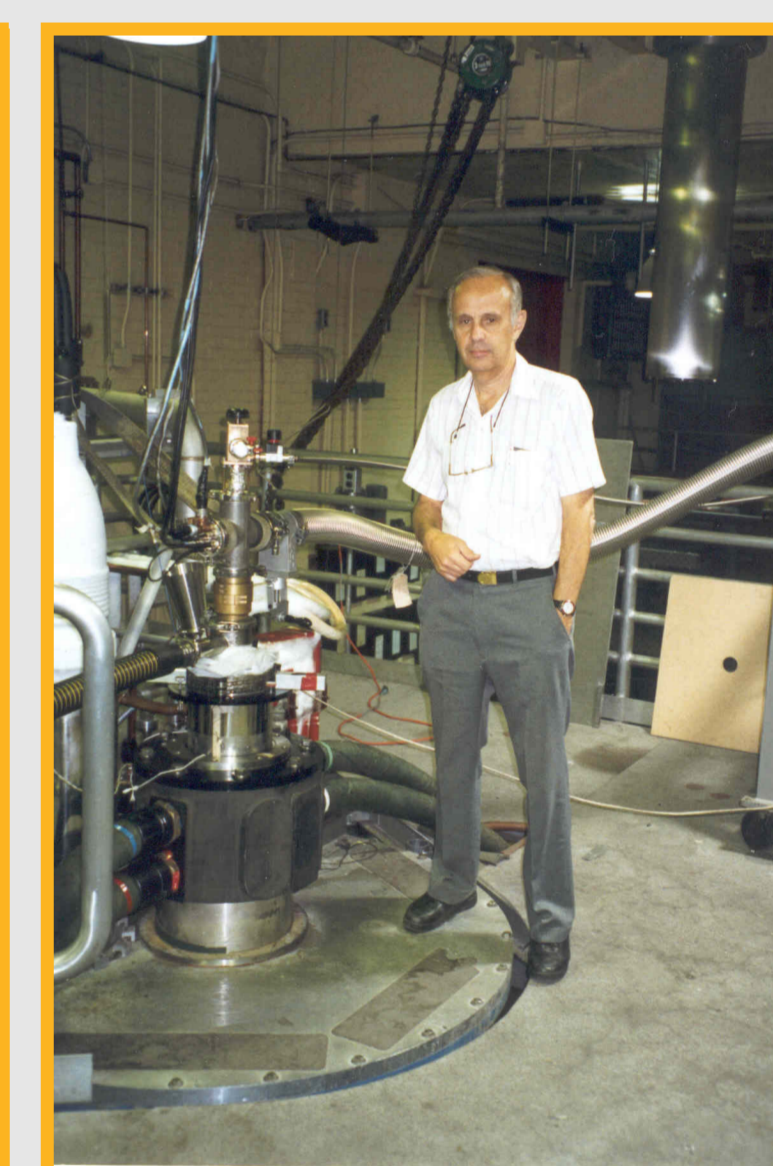
Detalhes de construção e montagem do refrigerador que operou a 0,02 K sob um campo magnético de 35 T, portando quatro experimentos diferentes, em 1995.
