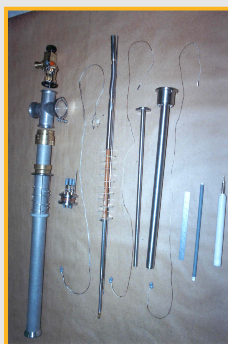
Detalhes de construção e montagem do refrigerador que operou a 0,02 K sob um campo magnético de 35 T, portando quatro experimentos diferentes, em 1995.
