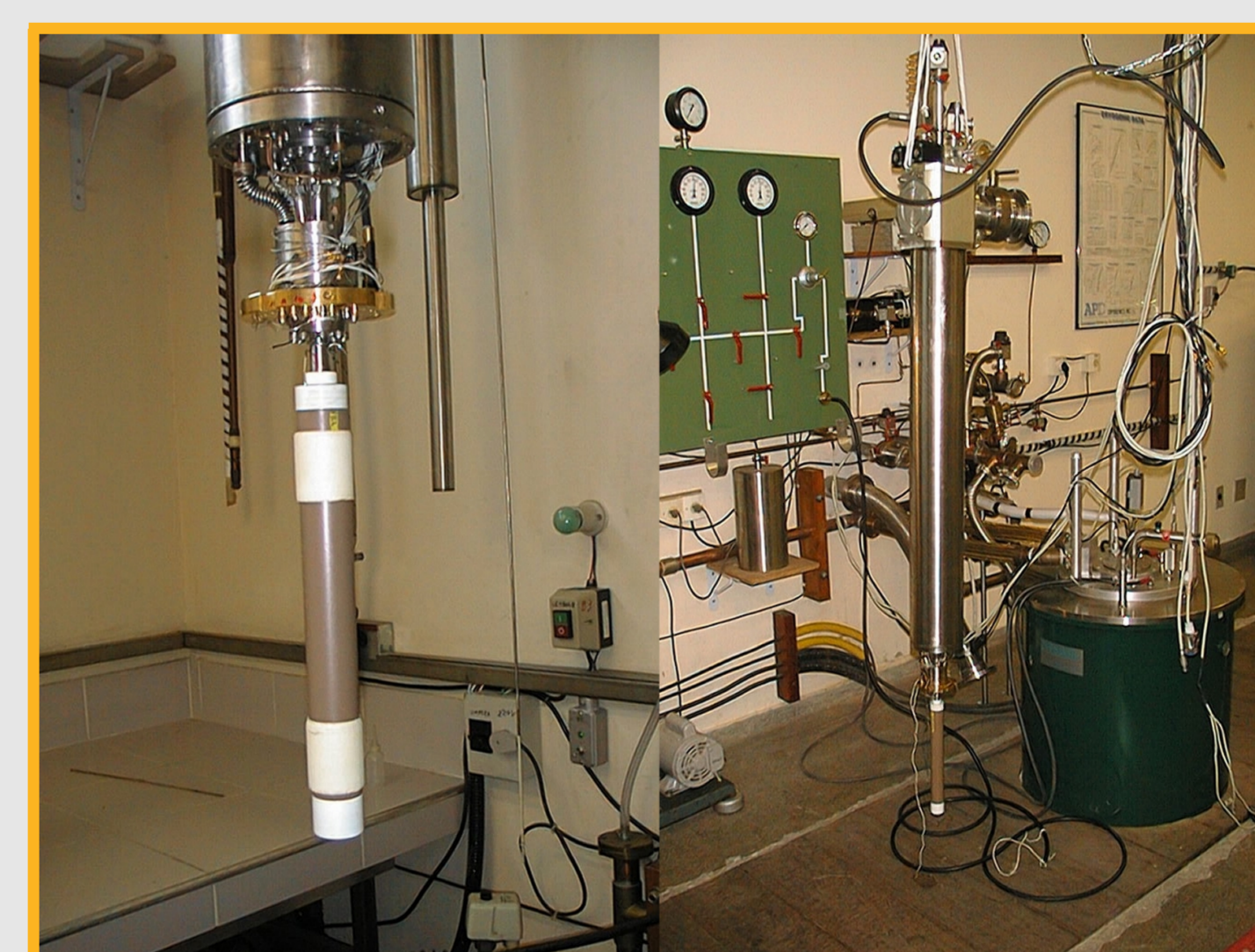
Estação de 18 T com magnetômetro (VSM) e com refrigerador de diluição plástico.
