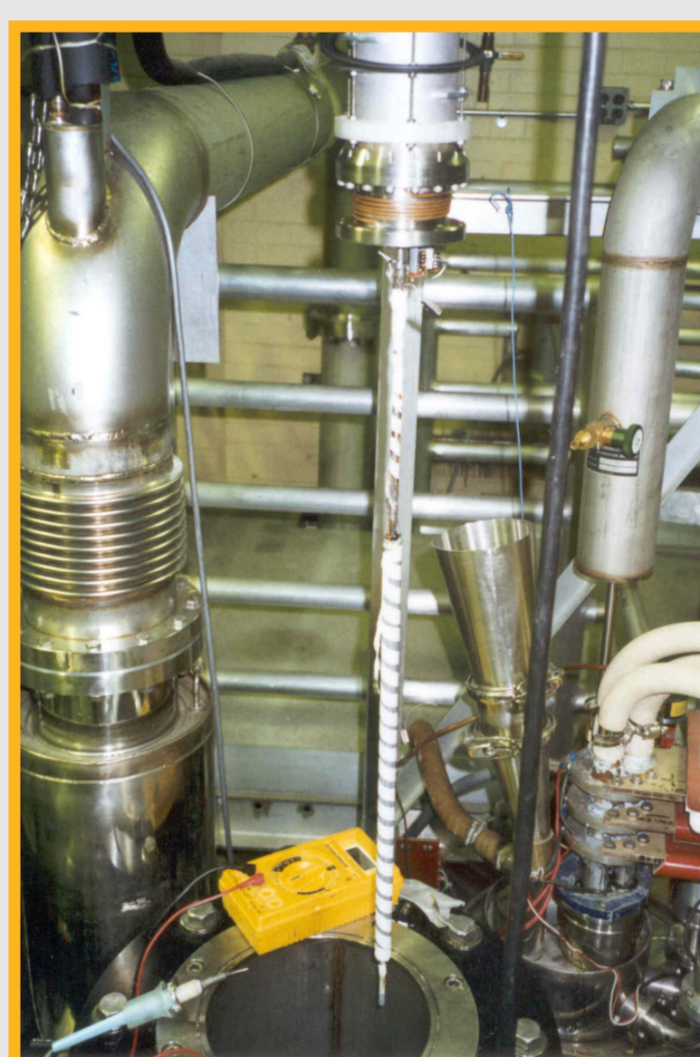
Detalhes de construção e montagem do refrigerador que operou a 0,02 K sob um campo magnético de 35 T, portando quatro experimentos diferentes, em 1995.
