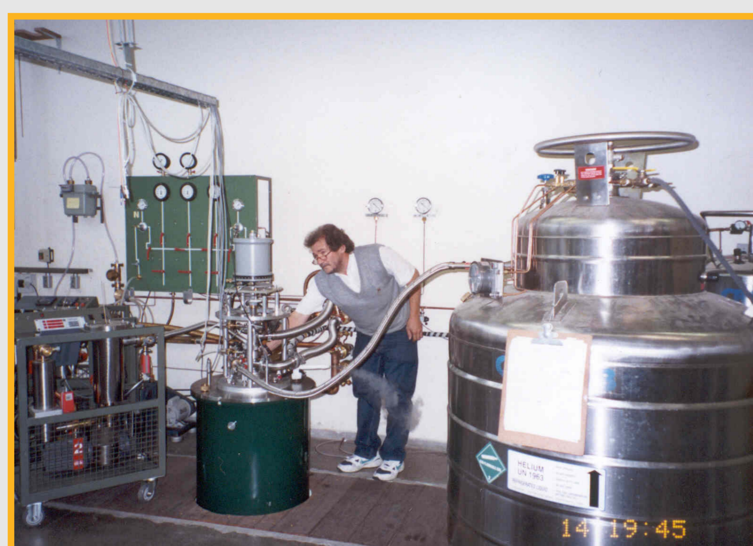
Estação de 18 T com magnetômetro (VSM) e com refrigerador de diluição plástico.
